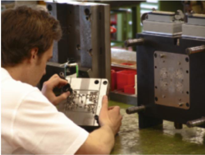
Contrôle de l'état de surface d'un moule d'injection
