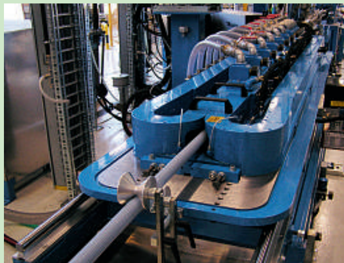
Fig. 3: Extrusion d'un tube de protection en ligne autour d'une tube multicouche chez Geberit Fabrication SA.
