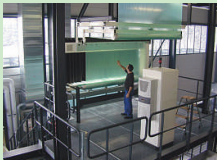
Fig. 2: Une fois extrudé, le film adhésif subit un contrôle optique, à l'aide de caméras et de l'œil humain, afin de repérer et de localiser d'éventuels défauts.
