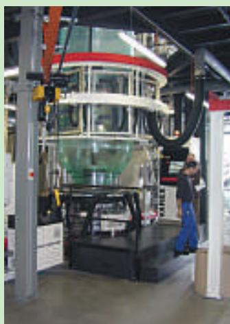
Fig. 1: L'extrusion-gonflage est une technique particulièrement spectaculaire d'extrusion qu'utilise Collano Services Extrusion AG pour la production de films adhésifs.
